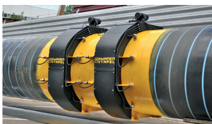
Рис. 4. Внешний вид магистрального ультразвукового измерительного комплекса «Вымпел-500» DN 1400
